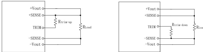
外加电阻分别于 TRIM 端与 Vo 之间,可使输出电压在 90%—110%Vo 范围内增大或减小。电阻加在 TRIM 端与 Vo+之间, 输出电压增大; 电阻加在 TRIM 端与 Vo-端之间, 输出电压减小。调整过程中,调整电阻尽可能的靠近模块电源的引针。不需要此功能时,TRIM 端悬空。
